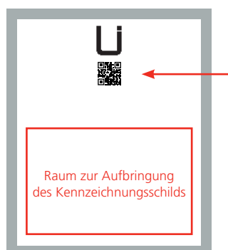
Bild 1: Innenseite des Mantelsteinverschlusses der unteren Putztüre
