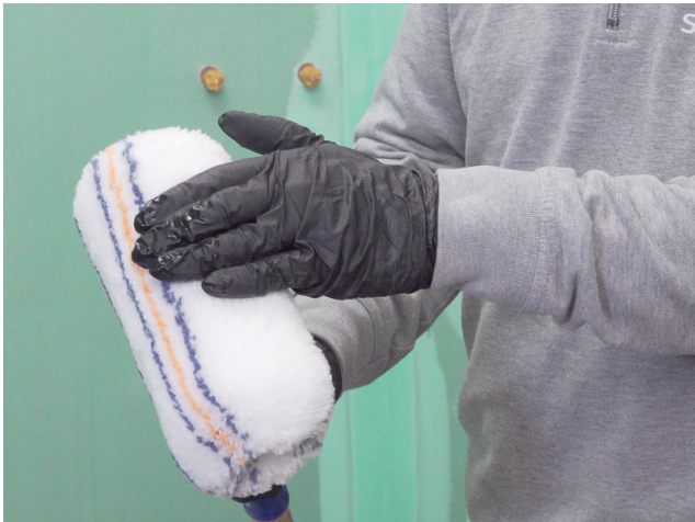
Für schnelle Arbeitsfortschritte beim Auftrag eine Lammfellrolle verwenden.
