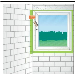
5. Bild: Folie mit einem Andruckroller anrollen
