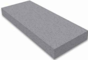
Druckbelastbare Bodendämmplatte aus Titan® (EPS-Hartschaum) gemäß DIN EN 13163 zum Einsatz zur Dämmung im Fußboden unter Estrich, ohne Trittschallanforderung. Druckfestigkeit, dm = mittlere Druckfestigkeit. Die Kantenausführung ist stumpf, optional mit Stufenfalz zur Vermeidung von Wärmebrücken lieferbar.
