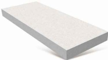
Druckbelastbare Bodendämmplatte aus Styropor® (EPS-Hartschaum) gemäß DIN EN 13163 zum Einsatz zur Dämmung im Fußboden unter Estrich, ohne Trittschallanforderung. Druckfestigkeit, ds = sehr hohe Druckfestigkeit. Die Kantenausführung ist stumpf, optional mit Stufenfalz zur Vermeidung von Wärmebrücken lieferbar.
