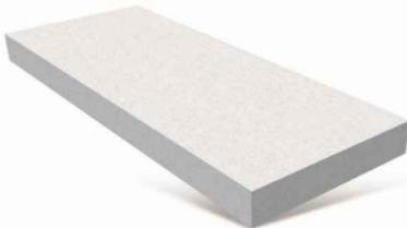
Druckbelastbare Bodendämmplatte aus Styropor® (EPS-Hartschaum) gemäß DIN EN 13163 zum Einsatz zur Dämmung im Fußboden unter Estrich, ohne Trittschallanforderung. Druckfestigkeit, dm = mittlere Druckfestigkeit. Die Kantenausführung ist stumpf, optional mit Stufenfalz zur Vermeidung von Wärmebrücken lieferbar.
