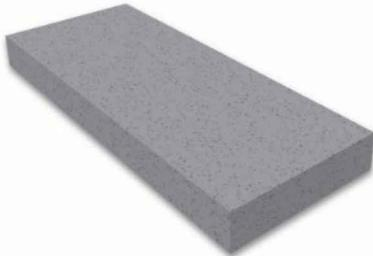
Druckbelastbare Bodendämmplatte aus Titan® (EPS-Hartschaum) gemäß DIN EN 13163 zum Einsatz zur Dämmung im Fußboden unter Estrich, ohne Trittschallanforderung. Druckfestigkeit, dh = hohe Druckfestigkeit. Die Kantenausführung ist stumpf, optional mit Stufenfalte zur Vermeidung von Wärmebrücken lieferbar.
