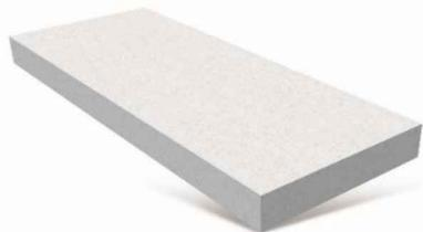
Druckbelastbare Bodendämmplatte aus Styropor® (EPS-Hartschaum) gemäß DIN EN 13163 zum Einsatz zur Dämmung im Fußboden unter Estrich, ohne Trittschallanforderung. Druckfestigkeit, dh = hohe Druckfestigkeit. Die Kantenausführung ist stumpf, optional mit Stufenfalz zur Vermeidung von Wärmebrücken lieferbar.
