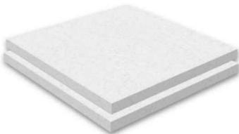
Druckbelastbare Flachdachdämmplatte aus Styropor® (EPS-Hartschaum) gemäß DIN EN 13163 zum Einsatz zur Außendämmung im Flachdach unter Abdichtung. Druckfestigkeit, dm = mittlere Druckfestigkeit. Die Kantenausführung ist stumpf, optional mit Stufenfalte zur Vermeidung von Wärmebrücken lieferbar.
