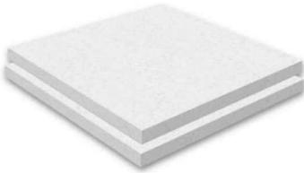
Druckbelastbare Flachdachdämmplatte aus Styropor® (EPS-Hartschaum) gemäß DIN EN 13163 zum Einsatz zur Außendämmung im Flachdach unter Abdichtung. Druckfestigkeit, dh = hohe Druckfestigkeit. Die Kantenausführung ist stumpf, optional mit Stufenfalte zur Vermeidung von Wärmebrücken lieferbar.
