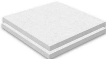
Druckbelastbare Flachdachdämmplatte aus Styropor® (EPS-Hartschaum) gemäß DIN EN 13163 zum Einsatz zur Außendämmung im Flachdach unter Abdichtung. Druckfestigkeit, ds = sehr hohe Druckfestigkeit. Die Kantenausführung ist stumpf, optional mit Stufenfalte zur Vermeidung von Wärmebrücken lieferbar.
