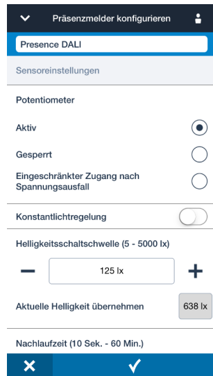
Abb. 41: Anpassen des Helligkeitssollwertes für die tageslichtabhängige Steuerung
