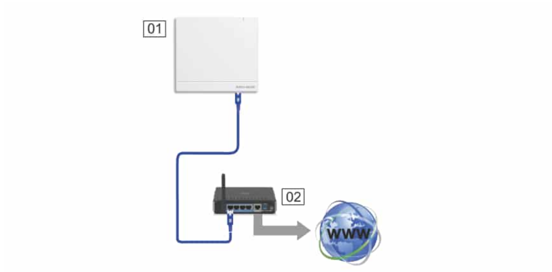
Abb. 14: Anbindung über Patchkabel
