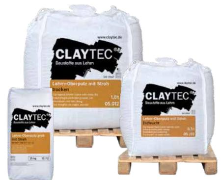
Einlagiger Oberputz im Innenbereich. Auf Lehm- Unterputz, ausreichend ebenen Mauerwerk und anderen Massivbaustoffen. Die Auftragsdicke liegt zwischen 6 und 10 mm. Lehm- Oberputz mit Stroh ist der Mörtel für jede Oberflächentextur, von rustikal bis geglättet. Das kurzgeschnittene Stroh ist nur dekorativ auf der Oberfläche, es macht den Putz geschmeidig und auch für Ungeübte gut verarbeitbar. Gestrichen wird der Putz mit dem ClayFix Lehm-Anstrichstoffsistem.
