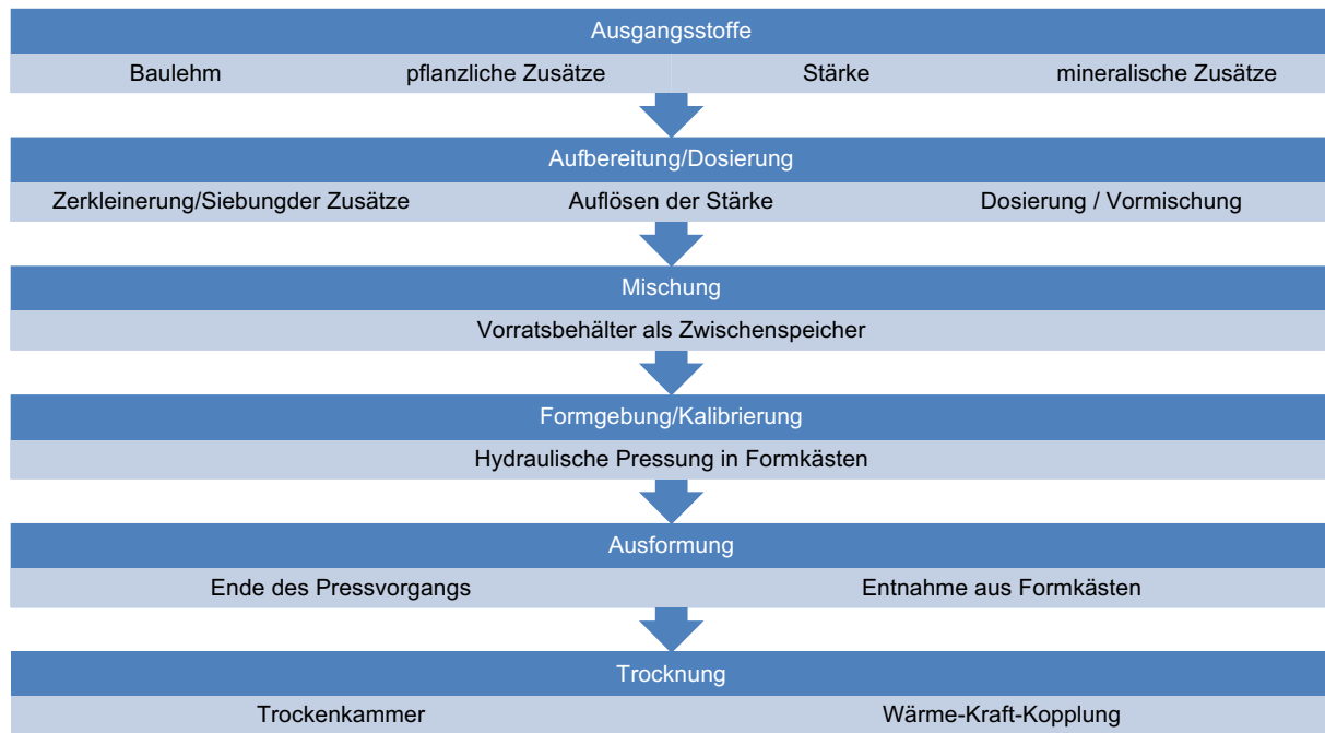
Bild 4.1 Herstellungsschema „Lehmplatten, formgepresst“
