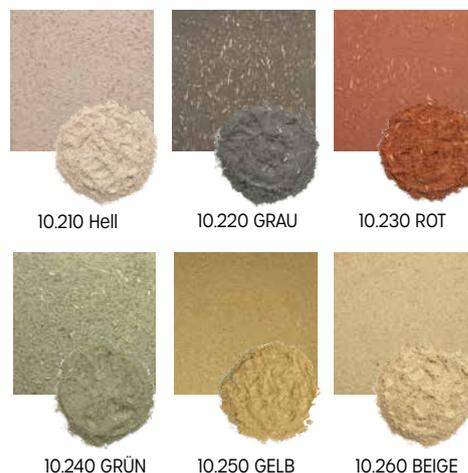
Einlagiger farbiger Oberputz im Innenbereich. Das Material wird in der Regel 6-10 mm dick aufgetragen. Es ist damit auch für Untergründe geeignet, die für den Auftrag eines Lehm-Dünnlagenfinishes zu uneben wären. Der dicke Auftrag erlaubt auch die Ausbildung grob-strukturierter Oberflächen. Lehm-Farbputz grob wird weder weiter beschichtet noch gestrichen. Dies spart nicht nur Kosten: Die Lehmoberfläche ist im Raum pur und eins-zu-eins erlebbar.
