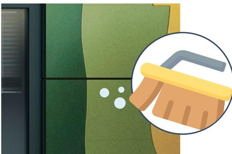
Vor der Montage sind der Staub (z. B. aus Zuschnitt, Vorbohren oder Kantenbrechung) oder anderweitige Verunreinigungen von den Fassadenplatten vollständig zu entfernen.
