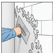
1. Alte Tapeten und Anstriche entfernen. Räue Untergründe mit gipshaltigen Spachtelmassen glätten. Stark saugende Untergründe mit lösungsmittelfreien Grundierungen grundieren.
