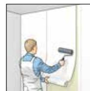
9. Klimaplatten sind ohne Armierung mit allen diffusionsoffenen Wandbelägen, Putzen und Beschichtungsstoffen etc. überarbeitbar.
