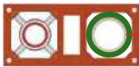
Bild 4: Überdruckabgasleitung CI/BÜ+i, zweizügig kombiniert mit Leistungsschornstein und Installationsschacht
