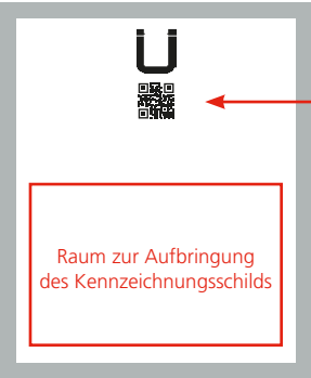
Bild 1: Innenseite des Mantelsteinverschlusses der unteren Putztüre
