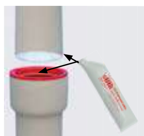
Bild 7b: Montage mit Elastomerdichtmanschette: Schritt 2: Mit Gleitmittel Innenseite der Manschette und Rohrspitze einfetten
