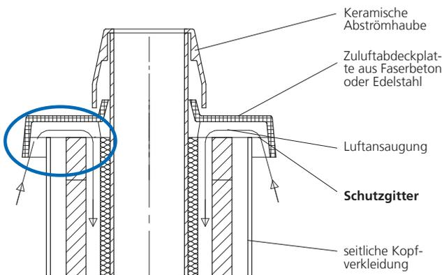
Beim ERLUS Leistungsschornstein kann und bei Kombinationen mit ERLUS Überdruckabgasleitungen muss die VK-Abdeckplatte (09) eingesetzt werden. Ebenso kann diese Platte auch als Entlüftungsöffnung für Systemen mit Heizraumentlüftungsschacht dienen.
