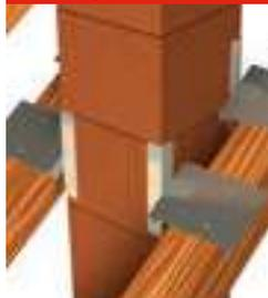
Nicht zusätzlich armierte Schornsteine sind generell im Dachdurchtritt seitlich abzustützen, um die Windkräfte sicher ableiten zu können. Dies kann einfach, schnell und sicher mit dem optionalen Erlus Sparrenhalter SP4 erfolgen.
