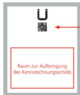
Bild 1: Innenseite des Mantelsteinverschlusses der unteren Putztüre
