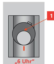
Luftanschlussblech mit Luft-Anschlussgummi achsgleich zum Abzweig des Stufenadapters mit Hilfe der vier Dübel und Schrauben am Schacht befestigen.
