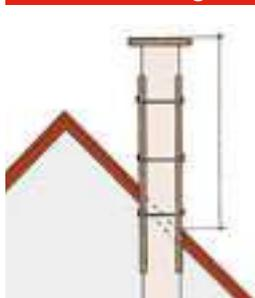
Eine andere Zusatzmaßnahme stellt das Erlus Aussteifungsset VS dar, welches auch nachträglich montiert werden kann. Es liegt außen korsettartig um den Schornstein und wird mit der Dachkonstruktion verschraubt. Eine separate Einbauanleitung liegt dem Aussteifungsset VS bei.
