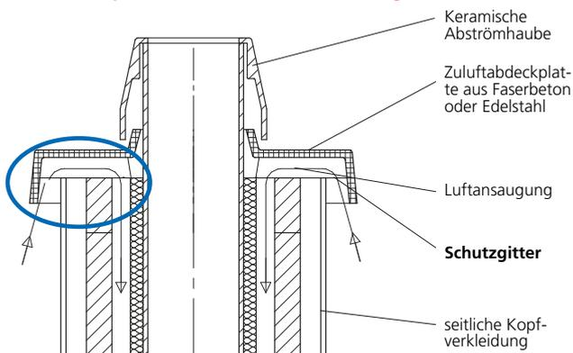
Beim ERLUS LAF-Premiumschornsteinsystemen und ERLUS Überdruckabgasleitungen kommt in der Regel die VK-Abdeckplatte (09) mit **untenseitiger Luftzuführung** zum Einsatz.
