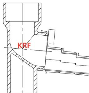
Der Stufenadapter ist der einzig zulässige Abgasanschlussadapter, wenn die optionale Kondensatrückführung KRF verbaut ist!
