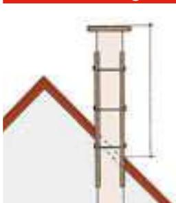
Eine andere Zusatzmaßnahme stellt das Erlus Aussteifungsset VS dar, welches auch nachträglich montiert werden kann. Es liegt außen korsettartig um die Abgasanlage und wird mit der Dachkonstruktion verschraubt. Eine separate Einbauanleitung liegt dem Aussteifungsset VS bei.
