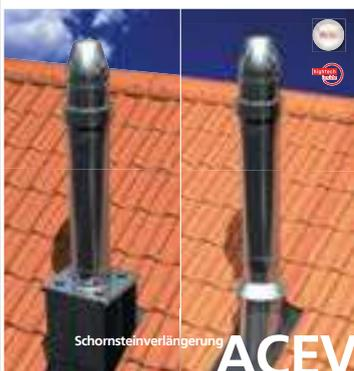
Optional kann eine ACEV-Schornsteinverlängerung für Überdruckabgasleitungen eingesetzt werden (bei zweizügigen Anlagen nur mit mittig liegendem Installationsschacht). Anstelle der VK-Abdeckplatte (09) wird eine Edelstahl-Übergangplatte geliefert, auf die der Edelstahlmantel mit Edelkeramikinnenrohr montiert wird. In diesem Fall ist zwingend das Vorhandensein des Statiksetz BS erforderlich (s. Seite 12). Der Wechsel kann über oder im Dach erfolgen.
