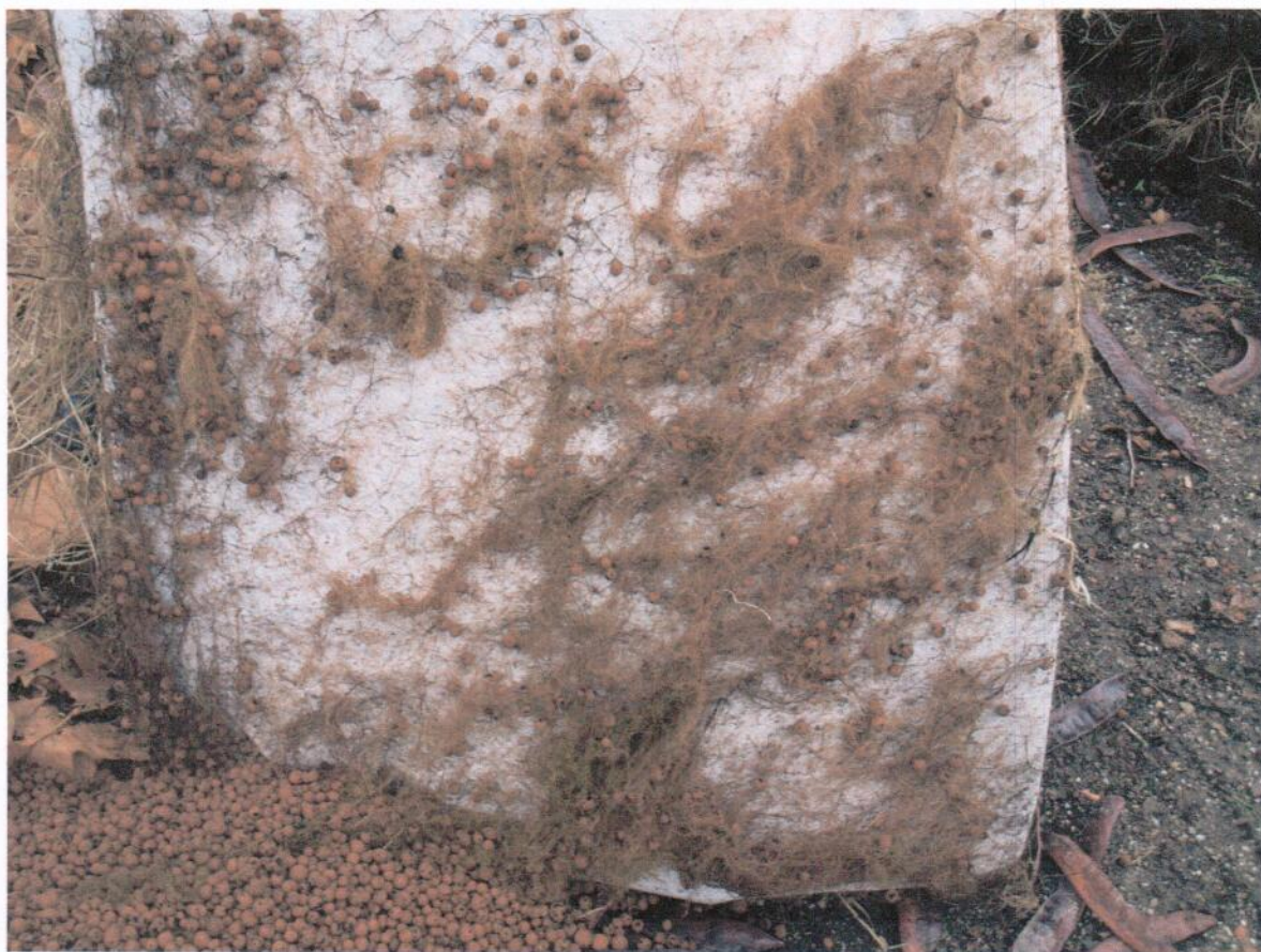
Abb. 3: Gut durchwurzelttes Schutz- bzw. Trennvlies (200 g/m 2 ) der Kontrolle
