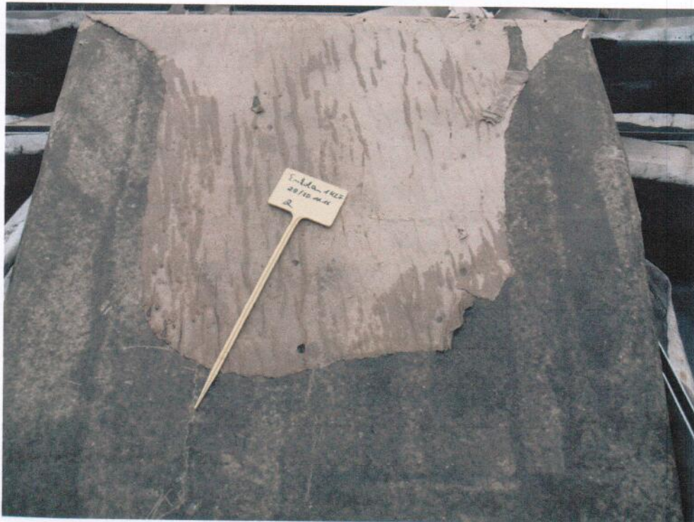
Abb. 2: Abdichtungsunterseite ohne Durchwurzlungen.
