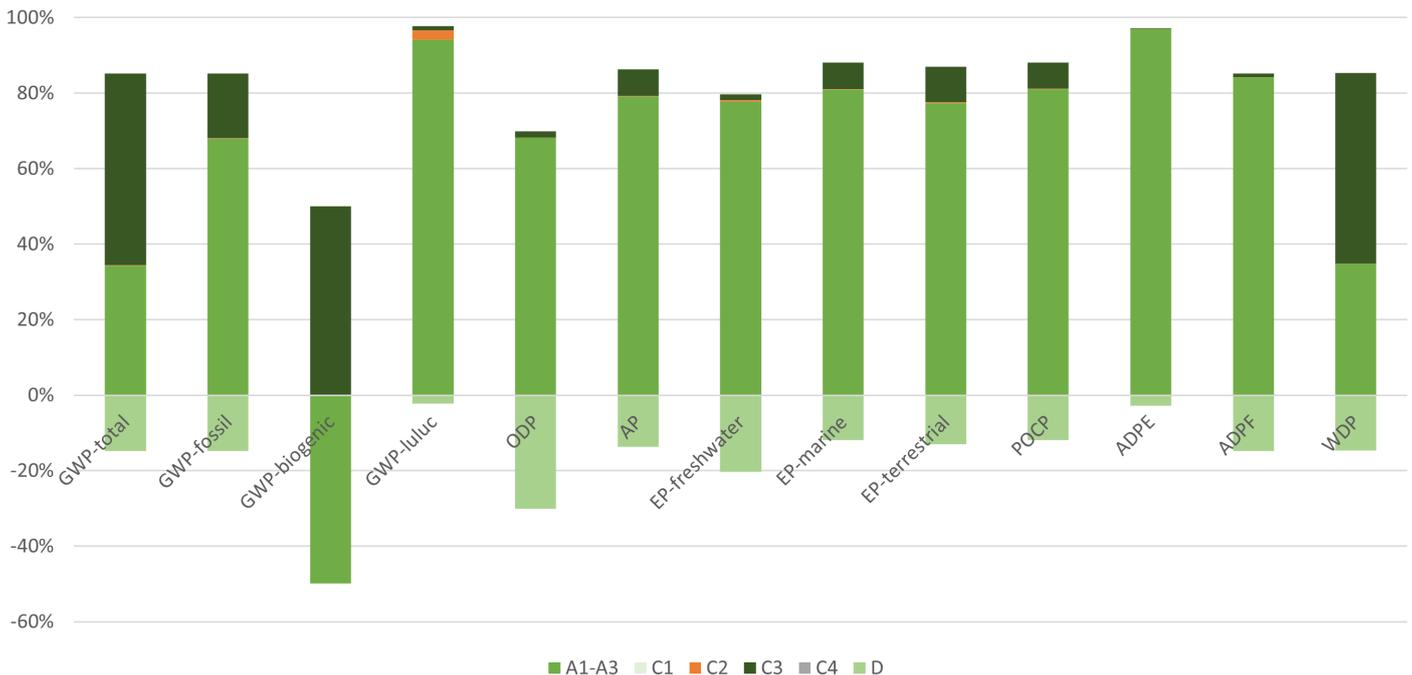
Stellt man die einzelnen Phasen gegenüber, so ergibt sich bei den betrachteten Indikatoren eine klare Dominanz der Produktionsphase (Module A1–A3). Die Umweltwirkungen der Produktionsphase sind hauptsächlich von der Lieferkette der Rohstoffe für den Kern der Platten dominiert.
