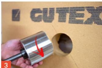
3 Das Auswurfsystem durch eine Drehbewegung öffnen.
