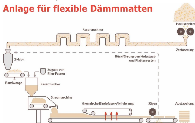
Abb.1: Schematische Darstellung des Herstellungsverfahrens der GUTEX Thermoflex.
