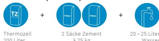
Das Anmischen unter Zugabe von Zement und Wasser erfolgt an der Baustelle. Durch unterschiedlich hohe Zementzugabe entstehen die Produkttypen pro 400, 250 und 160 speed mit den jeweiligen Eigenschaften.
