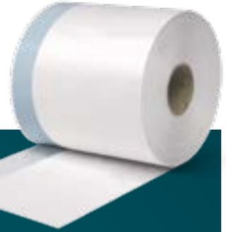
Für die schlagregendichte und diffusionsoffene Abdichtung der äußeren Fensteranschlussfuge eignet sich das Hanno®-Folienband FA-D. Es besteht aus einer dehnfähigen, dampfdiffusionsoffenen Vlies-Kombination.
