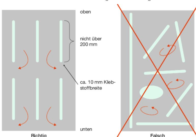
Bei der Klebung an Decken und bei der Klebung an Wände (wenn die Oberkante des Glases 4 m über der Bodenfläche liegt), muss das Glas zusätzlich mechanisch z. B. durch Schrauben bzw. Einlegen in Rahmen gesichert werden.
