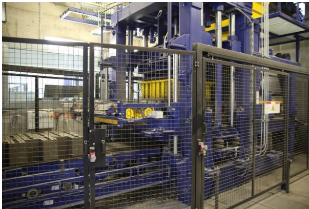
JASTO Fertigungsanlage: Steinmaschine,
