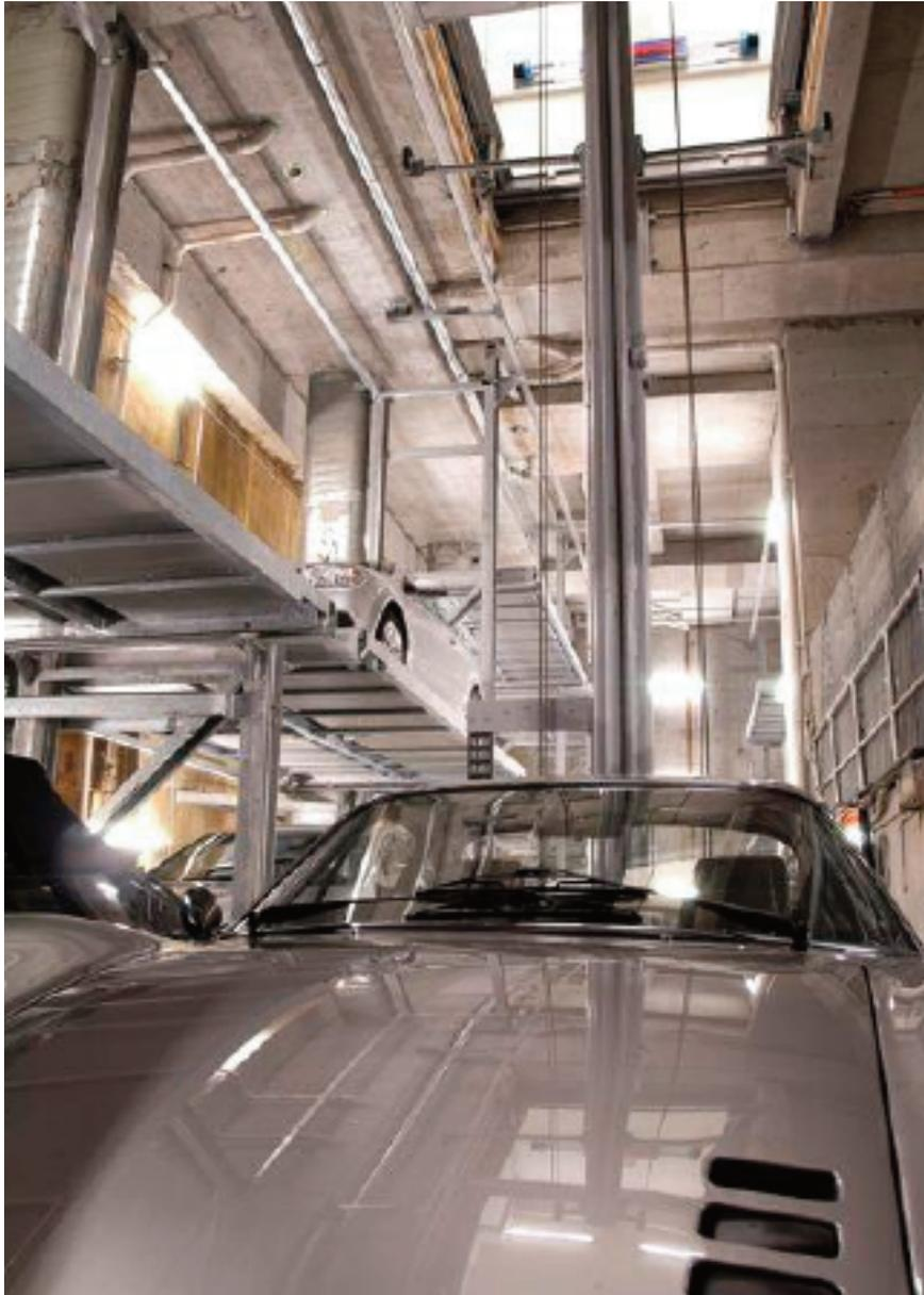
Das automatische Regalsystem ist ähnlich einem Hochregallager aufgebaut und besonders für schmale und lange Grundstücke geeignet.
