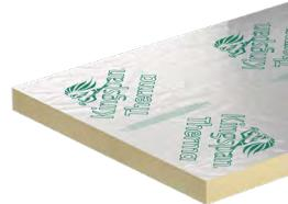
Geeignet sowohl für die lose Verlegung mit Auflast als auch für die mechanische Befestigung. Aufgrund des guten  $\lambda_D$ -Wert 0,022 sind geringe Aufbauhöhen möglich. Das spart Transport- und Verlegekosten. Das Gefälledachsystem Therma TT umfasst neben den Gefälledachdämmplatten Therma TT46 auch eine Standard Basisplatte sowie Kehl- und Gratplatten.
