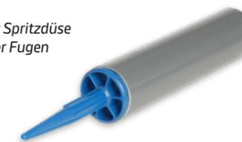
Setzen Sie die Spritztülle schräg in der Fuge an und füllen Sie die Fuge bei gleichmäßiger Rückwärtsbewegung vollständig, so dass ein ca. 3 bis 4 mm dicker überstehender Raupenwulst entsteht. Stoßen Sie, sobald die Spachtelmasse ansteift (ca. 45 Min. nach dem Anrühren), den Wulst mit Hilfe der Cleaneo-Spachtel ca. 1 bis 2 mm über der Plattenfläche ab.
