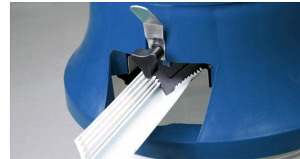
1. Metallschutzschienen passend ablängen und durch den mit pastöser Spachtelmasse (z. B. Superfinish) gefüllten Spachteltrichter Hopper ziehen.
