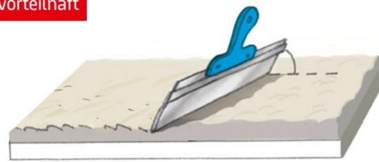
Bei steil gestelltem Werkzeug entstehen mehr Wellen im Untergrund.
