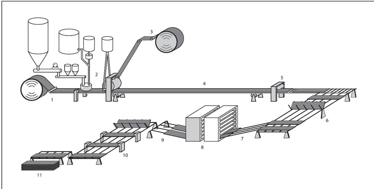
Abbildung 1: Fertigungsprozess von Gipsplatten nach /Gips-Datenbuch/
