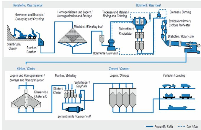
Die wichtigsten Zementrohstoffe Kalkstein, Ton und ihr natürliches Gemisch, der Kalksteinmergel, werden in Steinbrüchen hauptsächlich durch Sprengen gewonnen. Kreide und Ton lassen sich mit Eimerketten-, Schaufelrad- oder Schürfkübelbaggern unmittelbar von der Bruchwand abtragen.
