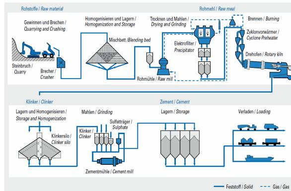
Die wichtigsten Zementrohstoffe Kalkstein, Ton und ihr natürliches Gemisch, der Kalksteinmergel, werden in Steinbrüchen hauptsächlich durch Sprengen gewonnen. Kreide und Ton lassen sich mit Eimerketten-, Schaufelrad- oder Schürfkübelbaggern unmittelbar von der Bruchwand abtragen.
