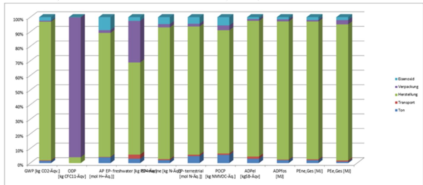
Die Auswertung der ökobilanziellen Ergebnisse der Riemchen zeigt auf, dass die Umweltwirkungen in allen Umweltkategorien speziell vom Energieverbrauch während des Herstellungsprozesses (Strom und speziell von der thermischen Energie aus Erdgas) im Werk beeinflusst werden. Die Verpackung, der Transport, der eingesetzte Ton und das Eisenoxid nehmen nur eine sehr untergeordnete bis marginale Rolle ein.
