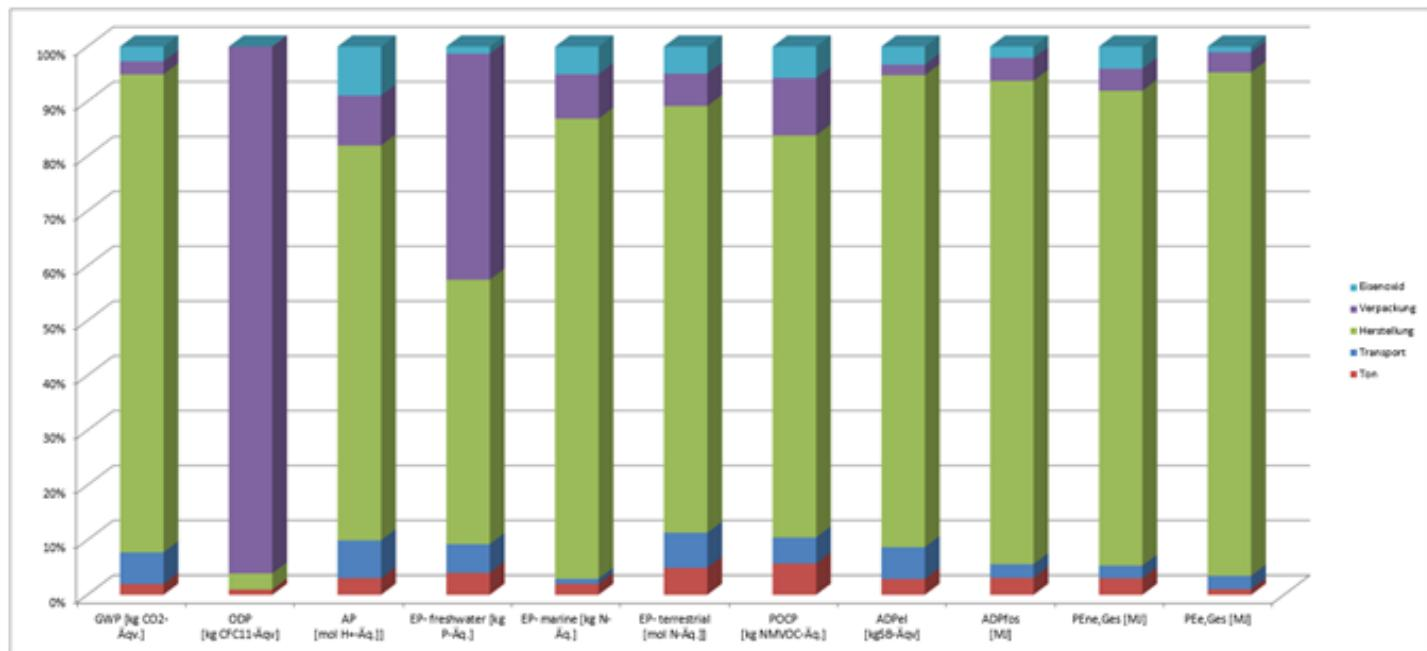
Die Auswertung der ökobilanziellen Ergebnisse der Vormauerziegel und Klinker zeigt auf, dass die Umweltwirkungen in allen Umweltkategorien speziell vom Energieverbrauch während des Herstellungsprozesses (Strom und speziell von der thermischen Energie aus Erdgas) im Werk dominieren werden.
