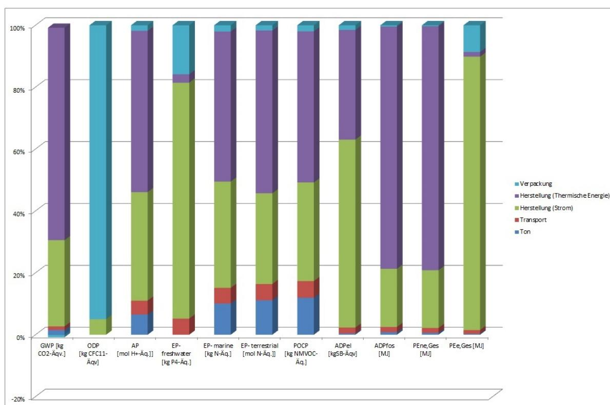
Die Auswertung der ökobilanziellen Ergebnisse der Dachziegel zeigt auf, dass die Umweltwirkungen in allen Umweltkategorien speziell vom Energieverbrauch während des Herstellungsprozesses (Strom und thermische Energie aus Erdgas) im Werk dominieren werden.
