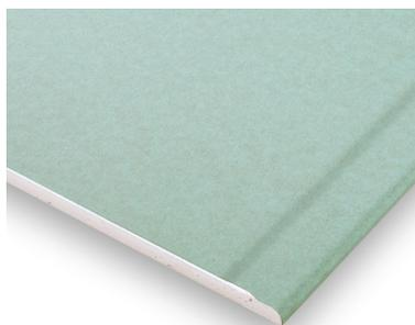
**Produktbeschreibung:** Kartonummantelte Gipsplatte nach DIN EN 520, Typ DFH2, kernimprägniert, verzögerte Wasseraufnahme, faserarmerter Gipskern und geschlossene Oberfläche.
