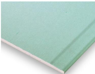
**Produktbeschreibung:** Kartonummantelte Gipsplatte nach DIN EN 520, Typ DFH2, kernimprägniert, verzögerte Wasseraufnahme, faserverstärkter Gipskern und geschlossene Oberfläche.
