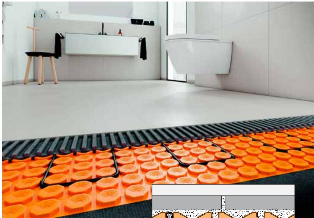
Der Fliesenbelag wird direkt auf DITRA-HEAT-PS/-DUO-PS den geltenden Regelwerken entsprechend im Dünnbettverfahren verlegt. Der Dünnbettmörtel verbindet sich mit der hinterschnittenen Noppenstruktur der DITRA-HEAT-PS/-DUO-PS Bahn.
