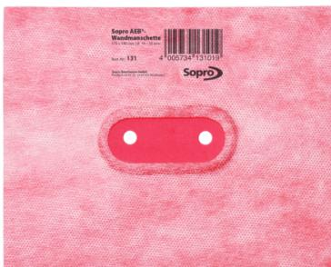
Flexible, alkalibeständige, zweifach gestanzte Dichtmanschette zum Abdichten von zwei nebeneinander liegenden Rohrdurchführungen von jeweils 10-16 mm unterhalb von Fliesen und Platten bei der Herstellung wasserundurchlässiger Systeme. Optimaler Haftverbund zu allen flüssig zu verarbeitenden und bahnenförmigen Sopro Abdichtungsstoffen.
