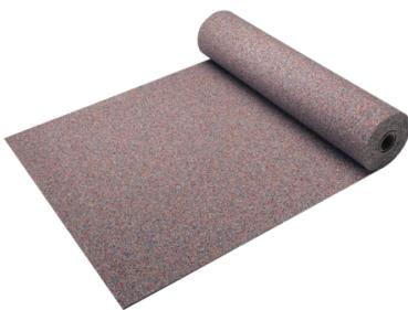
Gummigranulat-Bahn auf Recyclingbasis zur Verbesserung des Trittschall-dämmwertes bei sehr geringer Aufbauhöhe unter keramischen Fliesen und Platten sowie als entkoppelnde Zwischenschicht bei Sanierungen und im Neubau.
