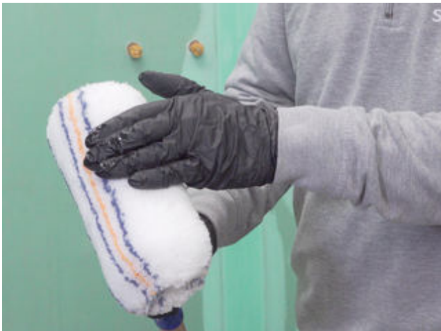
3 Für schnelle Arbeitsfortschritte beim Auftrag eine Lammfellrolle verwenden.
