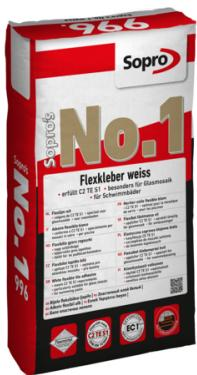
Zementärer, weißer Flexkleber, C2 TE S1 nach DIN EN 12004, mit hoher Kunststoffvergütung zum Ansetzen und Verlegen von keramischen Fliesen und Platten sowie Naturwerksteinfliesen. Besonders geeignet für Feinsteinzeug, in Schwimmbädern und auf Wand- und Fußbodenheizungen, sowie Glasmosaik. Vergütet mit Sopro megaFlex Dispersion auch zur Verlegung von Glasmosaik im Nass- und Unterwasserbereich geeignet. Geeignet auf Verbundabdichtungen.
