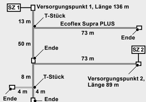
Sollte es nicht möglich sein, die Versorgung von zwei Richtungen und von verschiedenen Schaltzentralen aus zu gewährleisten, muss bei einer Versorgung von Schaltzentrale SZ 1 aus ein Erdkabel zum zweiten Versorgungspunkt verlegt werden.
