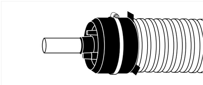
Fertig montierte Ecoflex Gummi-Endkappe Single.
