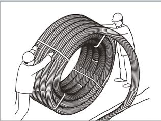
Verpackungsfolie entfernen. Das erste Nylonband am äußeren Rohrende öffnen, das Rohrende von der Rolle lösen und die Rolle erneut mit dem Nylonband fixieren. **Achtung**
