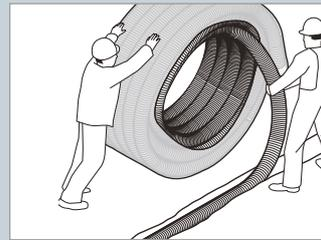
Äußere Verpackung nicht entfernen! Durchschneiden der Nygonsicherungsänder in der Rolle. Herausheben des inneren Rohrendes aus der Rolle (Endkappe bis zum Anschließen der
