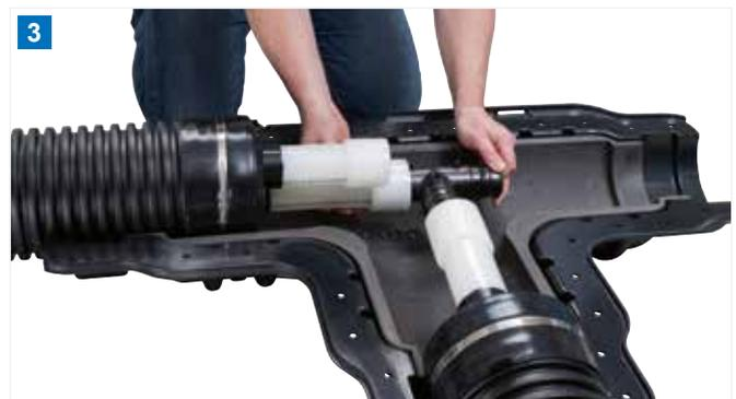
3 Schieben Sie das aufgeweitete Rohrende zügig bis zum Anschlag auf den Fittingnippel. Kurz halten, bis das Rohr aufgeschrumpft ist. Fertig!
