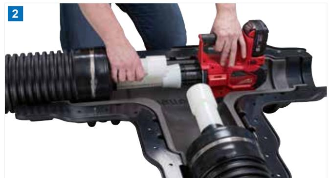
2 Weiten Sie das Rohrende auf. Für eine gleichmäßige Aufweitung wird dabei der Aufweitkopf im Rohrende durch die spezielle Werkzeugmechanik automatisch gedreht.
