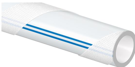
Uponor Comfort Pipe PLUS ist ein hochflexibles, mit Klettband umwickeltes 5-lagiges PE-Xa-Rohr mit den Abmessungen 14 mm × 2,0 mm und 16 mm × 2,0 mm.
