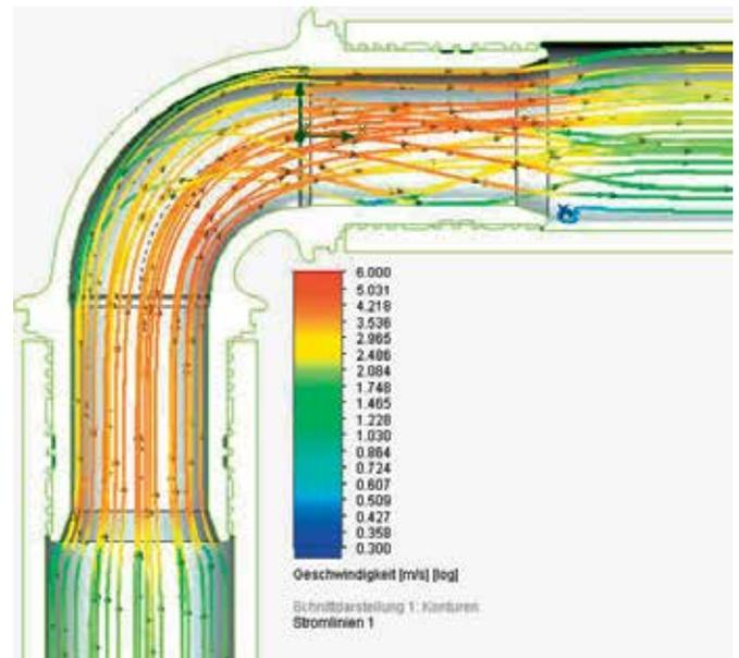
*Durchströmungsoptimiertes Fittingdesign. Die S-Press PLUS Radial-Pressverbindungstechnik ist tottraumfrei konstruiert und vermeidet damit jedes Risiko einer Verkeimung aufgrund von stagnierendem Wasser innerhalb des Fittings. Nachgewiesen durch mikrobiologische Untersuchungen am Institut für Umwelthygiene und Toxikologie in Gelsenkirchen.*
