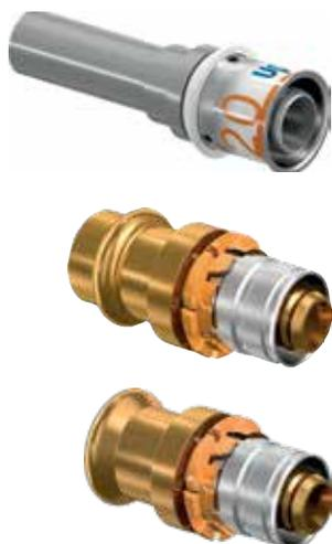
Besonders in der Sanierung oder Anlagenerweiterung sind die Uponor S-Press/PLUS Übergangsfittings die ideale Lösung für einen normgerechten Übergang auf ein bestehendes metallisches Rohrsystem. Die Fittingseite für den Anschluss der metallenen Rohre mit Normabmessungen wird nach Herstellervorgaben sowie mit deren zugehörigen Werkzeugen und Pressbacken verarbeitet. Die Uponor S-Press/PLUS Seite wird einfach und sicher mit dem Uponor Verbundrohr und der zugehörigen Uponor Pressbacke verbunden.
