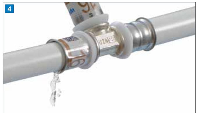
4 Unverpresste Verbindungen werden bei der Dichtheitsprüfung durch die unverpresst-undicht-Funktion sicher als undicht erkannt. Ein unverpresstes Fitting fällt zudem durch die noch vorhandene Indikatorfolie auf der Edelstahl-Presshülse deutlich auf.
