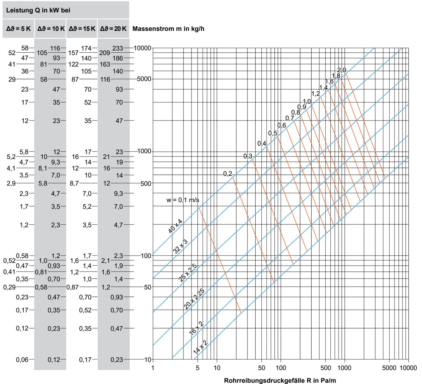
**Rohrreibungsdruckgefälle für Uponor Verbundrohre 50–110 mm in Heizungsinstallationen in Abhängigkeit vom Massenstrom bei einer mittleren Wassertemperatur von 60 °C**
