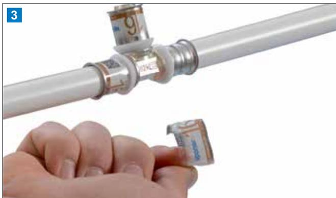
3 Nach dem Verpressen ist eine deutliche Verformung der Edelstahl-Presshülse sichtbar. Außerdem lässt sich die Folie nach erfolgreicher Verpressung einfach ablösen (Sichtkontrolle).
