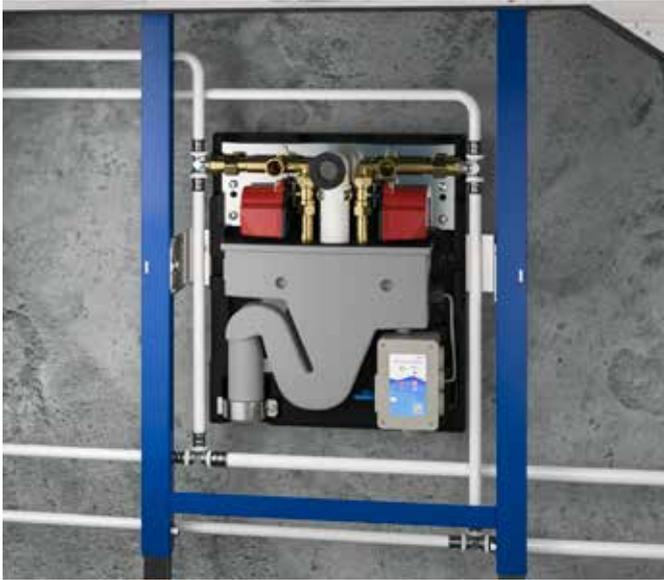
Uponor Motion ist eine montagefertige Spülstation zur automatisierten hygienischen Spülung von Kalt- und Warmwasserleitungen in Ring- und Reiheninstallation gemäß VDI/DVGW-Anforderungen. Werkseitig vorgefertigt inkl. Dämmschale mit Gehäuseschutz.
