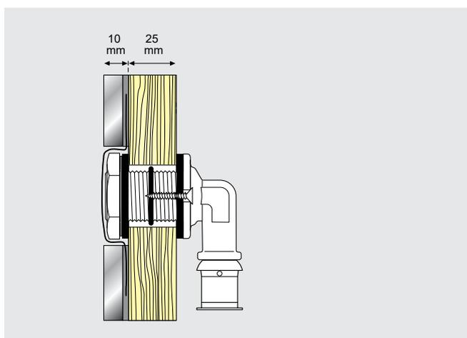
Verdrehsicherer Einbau in eine **Holzbeplankung** mittels handelsüblicher Holzschrauben
