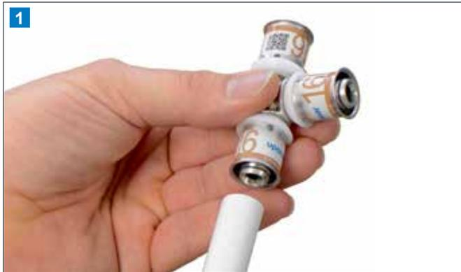
1 Uponor Verbundrohr in den Fitting einstecken. Das Rohrende muss zuvor nicht kalibriert und entgratet werden.
