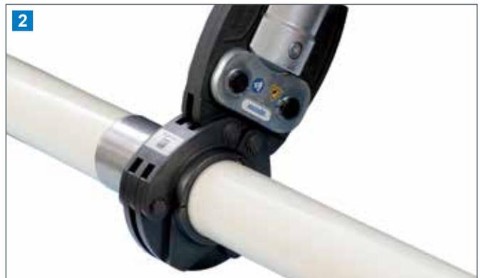
2 Basispressbacke in die Pressschlinge einhaken und Verpressung auslösen.
