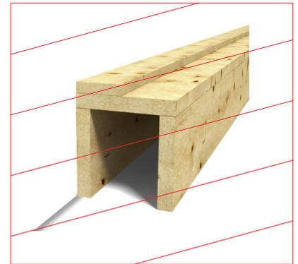
Holzprofil auf Holz (ohne Stahl): Grundsätzlich nicht von VELUX empfohlen. Nur zulässig bei Lichtbändern, Sheddach-Lichtbändern oben, Wandmontage-Lichtbändern unten.
