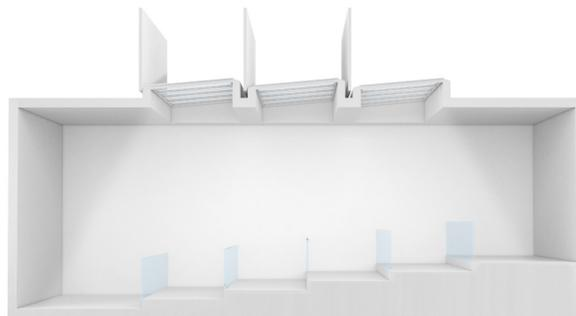
Atrium Lichtband mit außen liegendem Sonnenschutz. Design-Ideen wie vertikale Sonnenschutzvorrichtungen werden nicht von VELUX angeboten.
