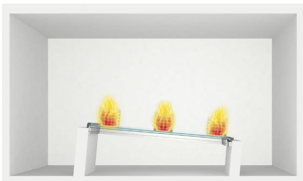
Prüfung 4 – zweistufig mit Brandsatz, Wind und zusätzlicher Strahlung
