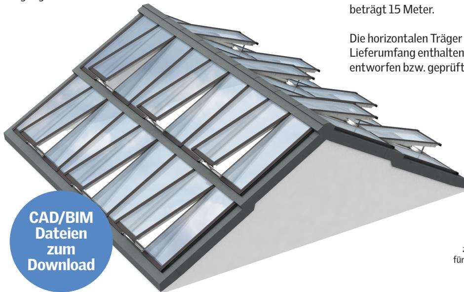
Das Stufen-Sattel-Lichtband 5° – 25° auf Träger wird auf 100 mm breiten Standard-Stahlprofilen montiert (nicht im Lieferumfang von VELUX enthalten).
