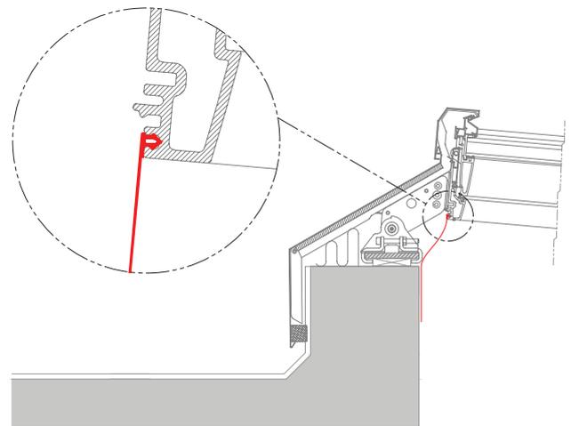
Position des Dampfsperre-Anschlussstreifens BCX
