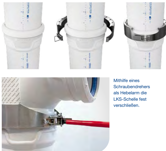
Abb. 37: Montageschritte Wavin LKS-Schelle
