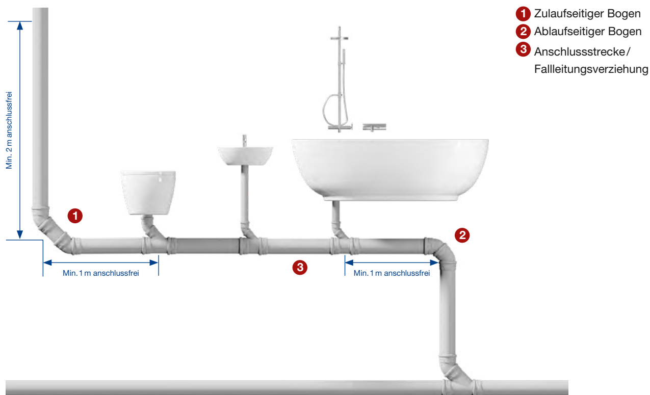
Abb. 8: Falleitungsverziehung > 2 m und anschlussfreie Leitungsbereiche
