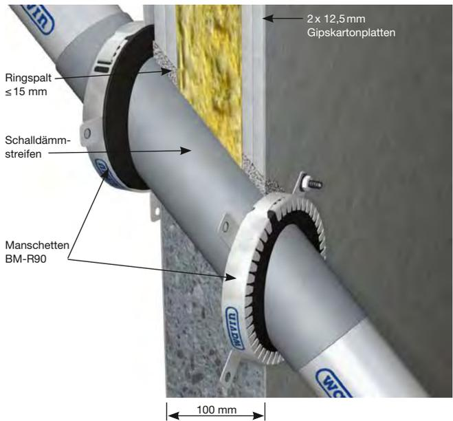
⊙ Rohrführung mit 45° Rohrdurchführung ohne oder mit Muffe/Formteil
