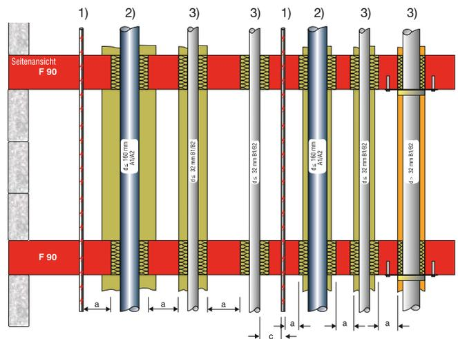
Alle Abstände a gelten bei gedämmten Rohrleitungen 50 mm.
