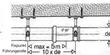
Die Einschublänge ergibt sich aus der Montagetemperatur. Bei 20 °C beträgt sie 10,5 cm, bei 0 °C nur 8 cm.
