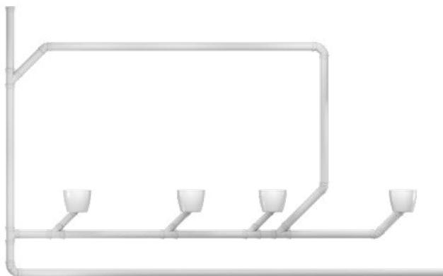
Abb. 18: Umlüftungsleitung
