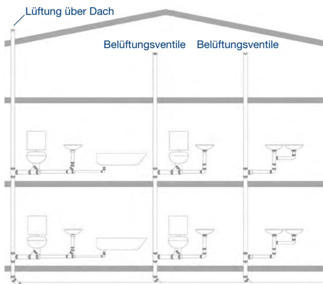
Abb. 20: Verwendung von Belüftungsventilen im Ein- oder Zweifamilienhaus
