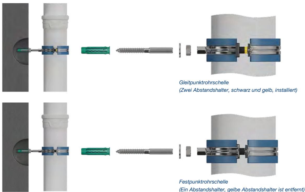
Abb. 42: Wavin Schallschutzrohrschelle
