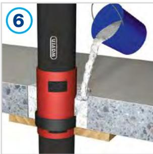
Durchbruch (Wand/Decke) durchgehend mit Beton oder Mörtel verschließen. Bei Leichtbauwänden muss der Ringspalt (siehe Seite 60/61) 25 mm tief mit Gips verschlossen werden.
