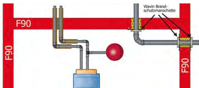
Wavin Abwassersysteme dürfen in Brennstofflagerräumen innerhalb von Gebäuden entsprechend der Feuerungsverordnung FeuVo § 12 eingesetzt werden.
