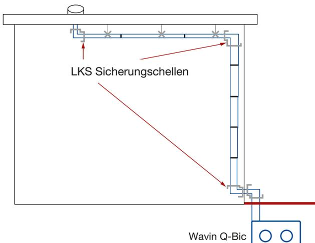
Die Wavin LKS-Schellen sind für die Schallschutzrohrsysteme Wavin AS+ und Wavin SiTech+ in den Dimensionen DN30 – 150 lieferbar.
