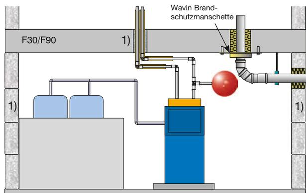
Abb. 26: Brennstofflagerräume und Heizraum getrennt mit: >5.000 Liter Heizöl oder > 15.000 kg Festbrennstoffe oder > 14 kg Flüssiggas.
