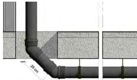
Gleichfalls sind Abwasserleitungen so zu dimensionieren und zu verlegen, dass neben dem abfließenden Wasser die Luft frei zirkulieren kann.
