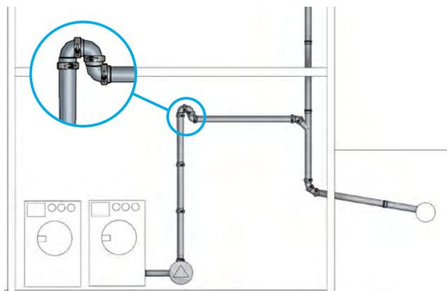
Hinter Pumpen und Hebeanlagen kann es in der gesamten Installation zu Druckschlägen kommen. Daher sind alle Formteile mit LKS-Schellen auszustatten. Es ist sicherzustellen, dass aufgrund von Druckstößen eine ausreichende Befestigung gewählt wird. Die auftretende dynamische Belastung muss an das Tragwerk abgeleitet werden.
