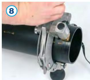
**8. Alternativ kann bei Rohrleitungen 75 – 315 mm der Rotationsschaber Typ RTC 315 (siehe Seite 166) zum Einsatz kommen.**
