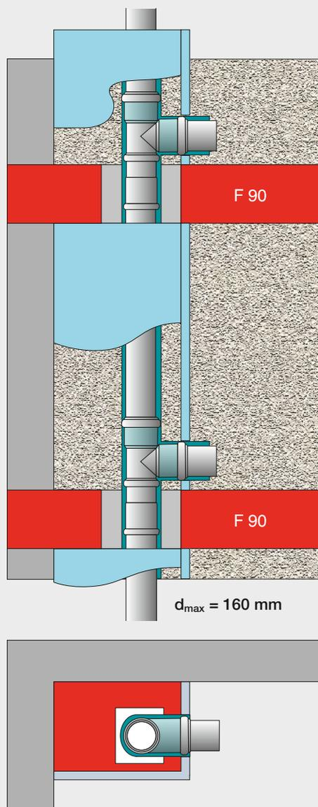
Abb. 31: Unterputzinstallation (Mauerschlitz)
